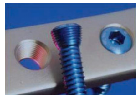
Abb. 8 Kopfverriegelnde Schraube: Die Schrauben verbinden sich über ein Gewinde am Außenrand des Schraubenkopfes winkelstabil mit einem Gewinde im Plattenloch.
